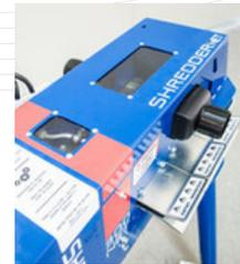
Auf der Oberseite der Gehäuseabdeckung befindet sich ein Sichtfenster, mit dem Sie jederzeit den Arbeitsvorgang überwachen können. Dadurch...
