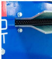
Die Einlassführung für die Kartonnagen wurde bei der HyPro-Serie so gestaltet, dass ein maximaler Schutz für die Finger der Bediener gewährleistet ist. Ein zusätzlicher Not-Stop-Schalter ist ebenfalls an allen Geräten vorhanden.
